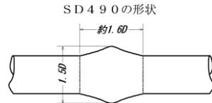
圧接部の膨らみ1.5Dで、裾野が広くなだらかな形状に形成します。膨らみの長さは1.5D～1.7Dがベストです。
